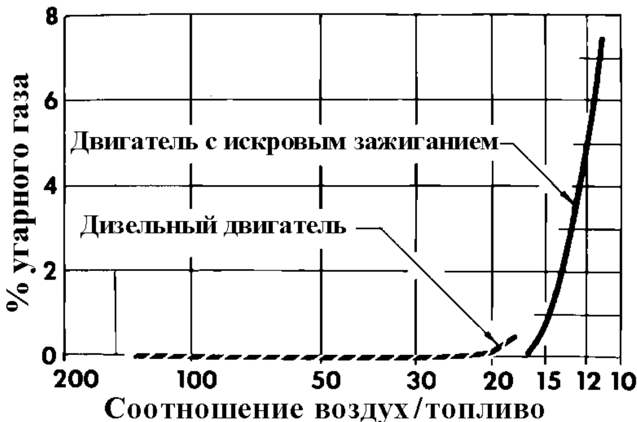
Рис. 3. Сравнение выделений угарного газа из дизельных двигателей и двигателей с искровым зажиганием[34]
