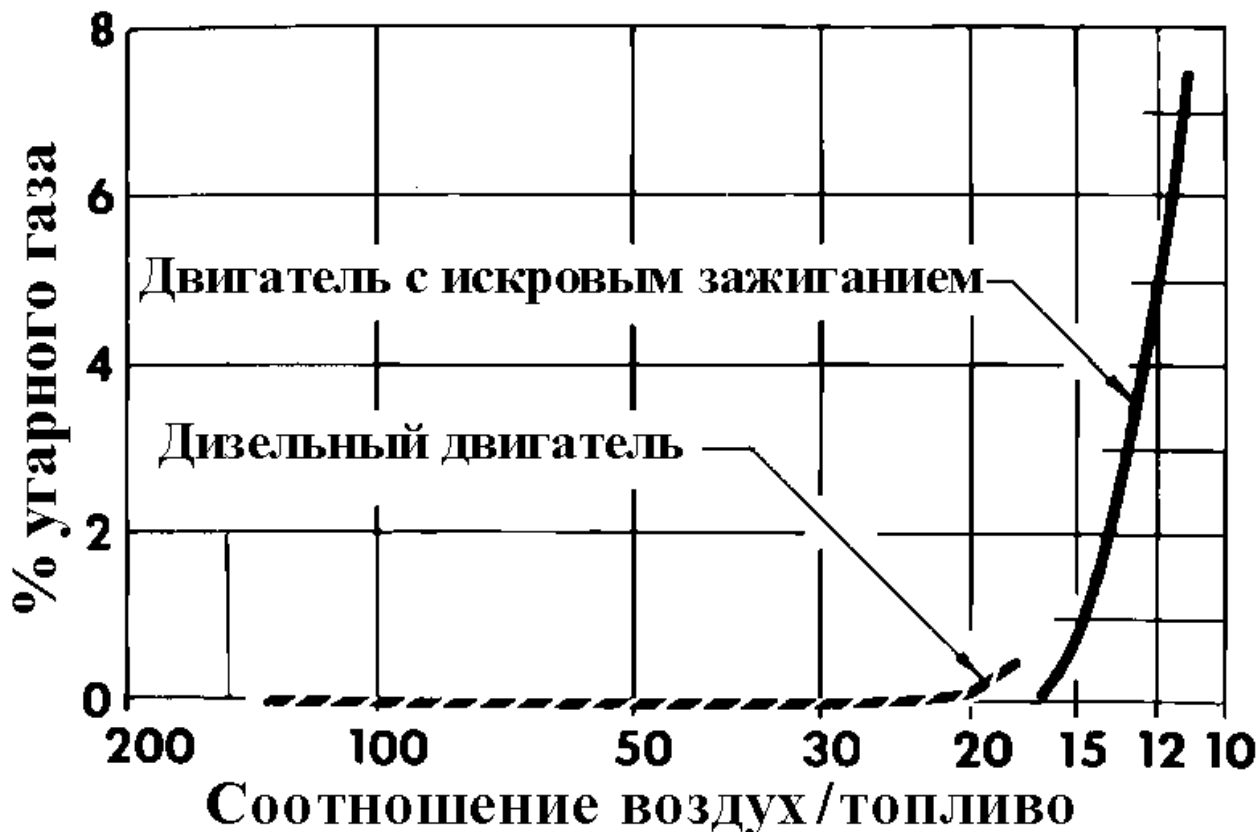
Рис. 3. Сравнение выделений угарного газа из дизельных двигателей и двигателей внутреннего сгорания[34]
